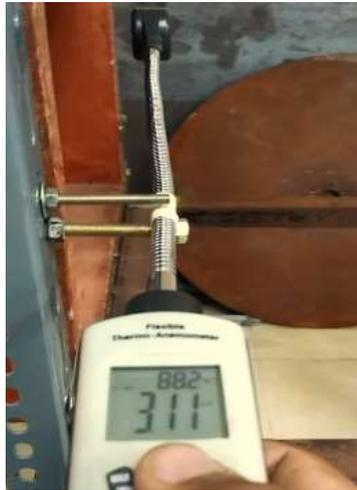
Gambar 10. Pengukuran Kecepatan Angin
