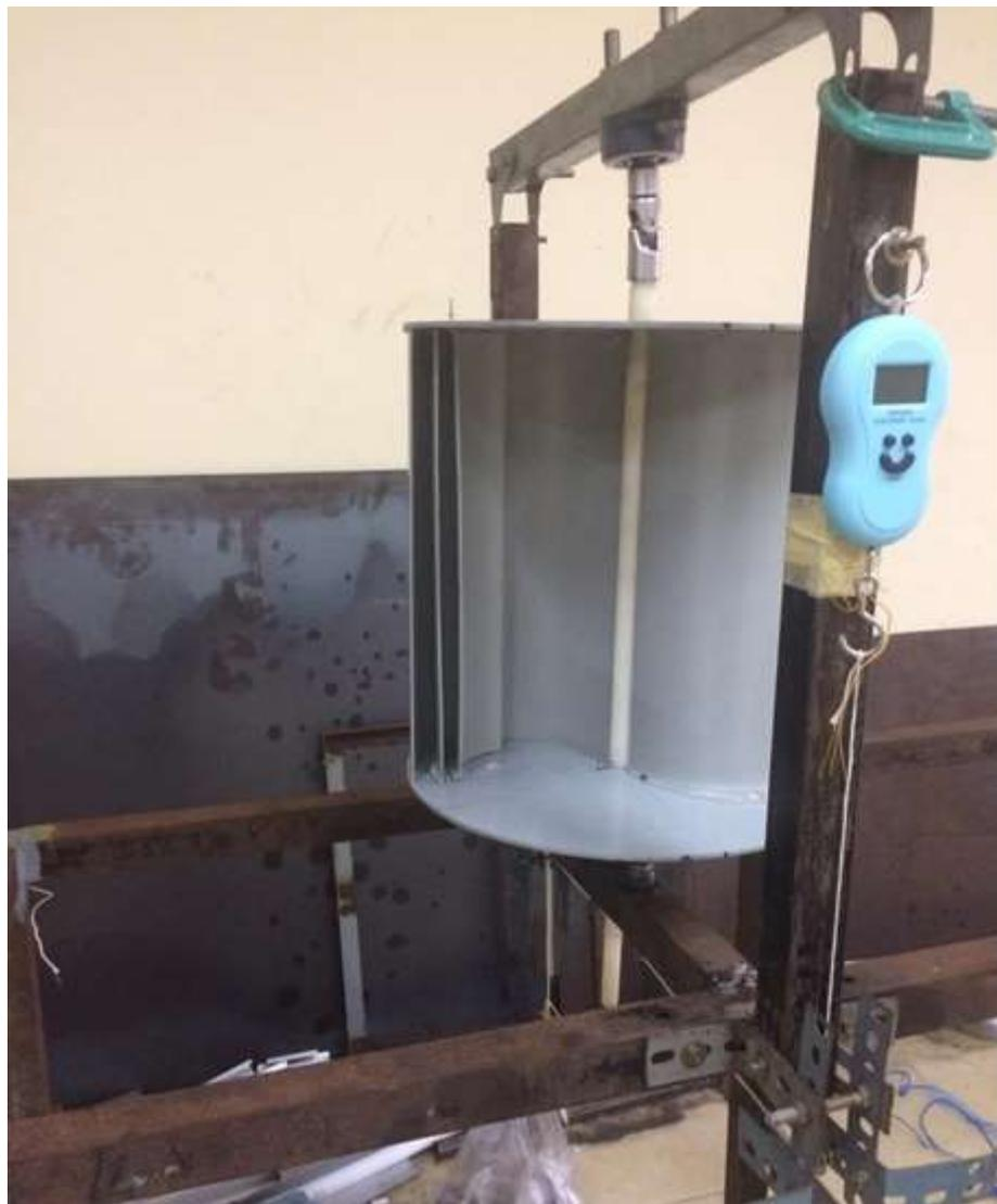
Gambar 6. Benda uji model turbin angin *savonius* satu tingkat dengan penambahan bilah pengganggu di *wind tunnel*
